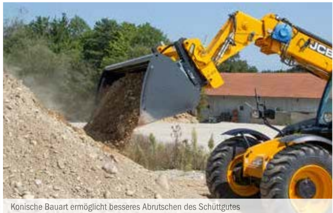
Konische Bauart ermöglicht besseres Abrutschen des Schüttgutes
