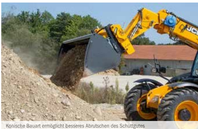
Konische Bauart ermöglicht besseres Abrutschen des Schüttgutes
