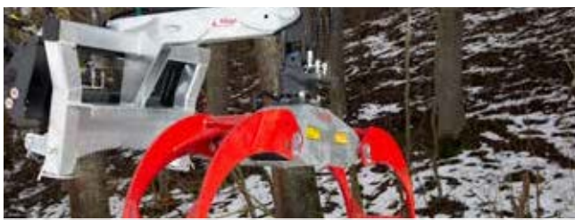
Hydraulische Rückezege Combi Plus RZ 185 mit Endlosdrehmotor
