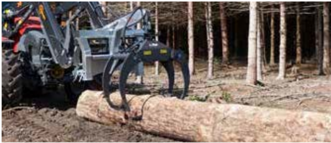
Hydr. Rückezege Combi RZ 185 mit mechanischem Drehgelenk
