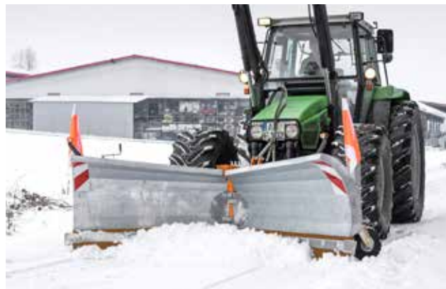
2 hydraulisch schwenkbare Flügel - diese lassen sich separat steuern, sodass individuelle Winkel-, Pflug- oder V-Stellungen gewählt werden können.
