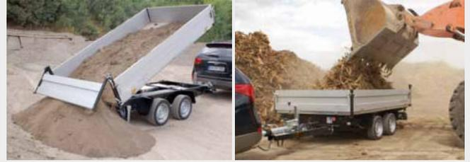
kippar, mit elektrischer Hydraulikpumpe
