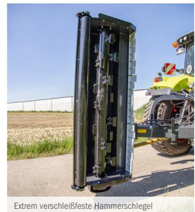
Extrem verschleißfeste Hammerschlegel
