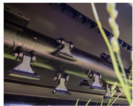
Abb.: extrem verschleißfeste Hammerschlegel
