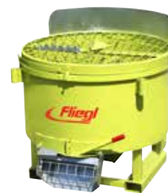
Mischmeister Favorite 800 Stundenleistung: ca. 12 cbm Kraftaufwand: ab 90 PS Einfülldurchmesser: 1300 mm
