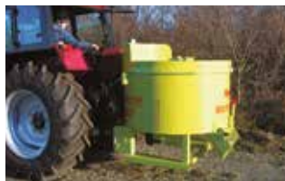
Mischmeister Favorite 600 Stundenleistung: ca. 10 cbm Kraftaufwand: ab 50 PS Einfülldurchmesser: 1200 mm
