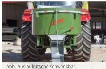
Abb. Auslaufrutsche schwenkbar
