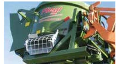
Abb. hydr. Antrieb und Laderaufnahme
