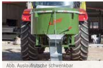
Abb. Auslaufrutsche schwenkbar
