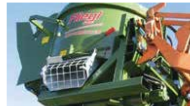
Abb. hydr. Antrieb und Laderaufnahme
