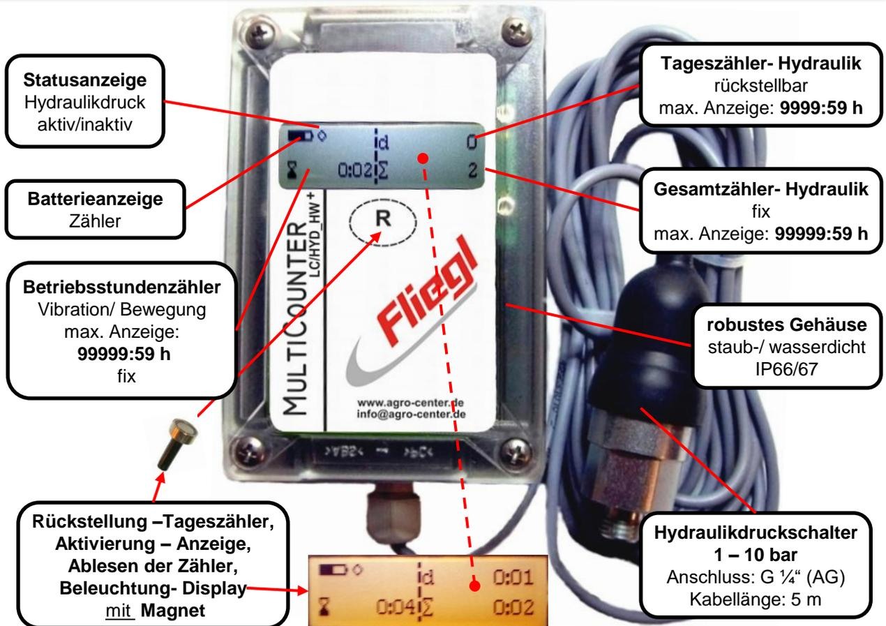
**Betriebsstundenzähler** für Maschinen, Fahrzeuge, Geräte mit Hydraulik
