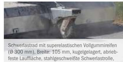
Schwerlastachse mit superelastischen Vollgummireifen (Ø 300 mm), Breite: 105 mm, kugelgelagert, abriebfeste Lauffläche, stahlgeschweißte Schwerlastrolle, schwere Drehkranzausführung
