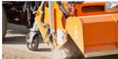
Serienmäßig mit Freikehrmodus: Kehren mit geöffneter Schmutzsammelwanne
