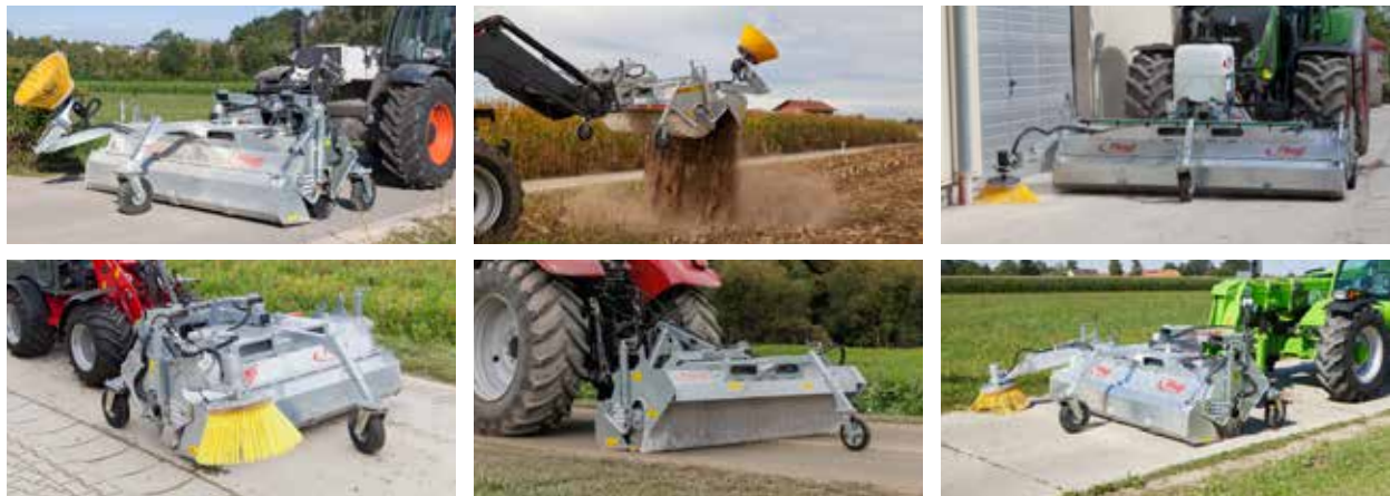
KEH Typ 500 mit Dreipunktaufnahme, hydraulische Schmutzsammelwanne, Seitenbesen und Frontstützrad
