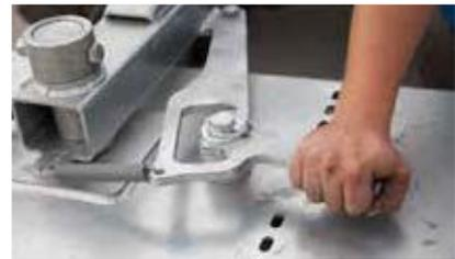
Schwenkbock mechanisch (30° nach links und rechts)
