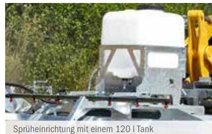
Sprüheinrichtung mit einem 120 l Tank
