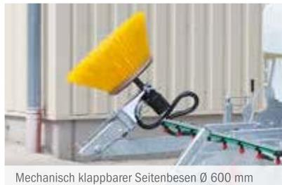
Mechanisch klappbarer Seitenbesen Ø 600 mm
