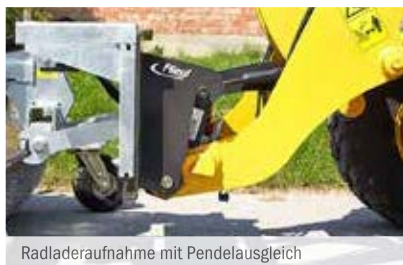
Radladeraufnahme mit Pendelausgleich
