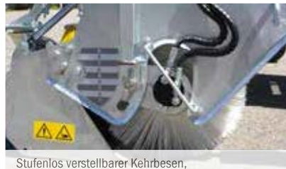
Stufenlos verstellbarer Kehrbesen, bis zur äußersten Verschleißgrenze abnutzbar
