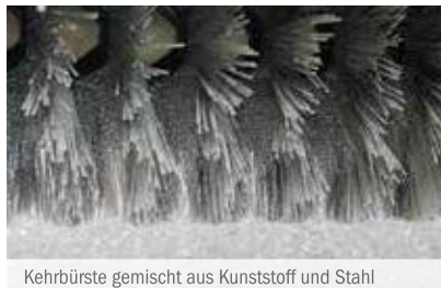
Kehrbürste gemischt aus Kunststoff und Stahl
