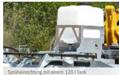
Sprüheinrichtung mit einem 120 l Tank
