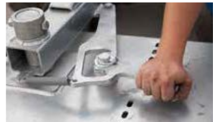
Schwenkbock mechanisch (30° nach links und rechts)
