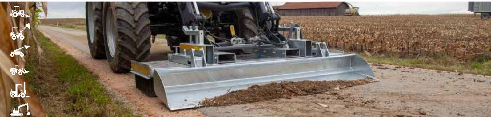
Abb. Mit Euronorm- und Schaufelaufnahme sowie einer hydraulisch klappbaren Schmutzsammelwanne (optional erhältlich)
