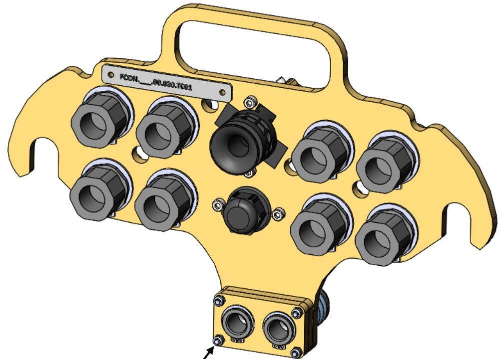
Lochbleche für Duomatic-Anschlüsse sind mit den 4 Schrauben so mit dem Bedienteil verschraubt, dass die Duomatic-Anschlüsse im Bedienteil leicht beweglich sind
