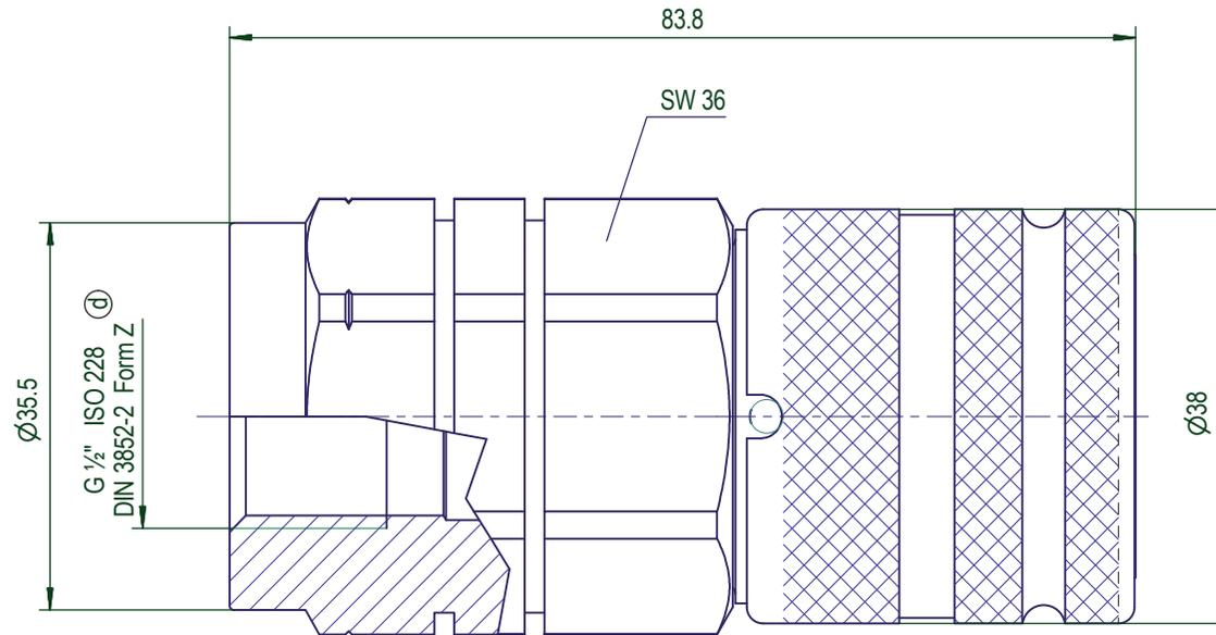
\* Bei genormten Gewindeanschlüssen ist bei der Festlegung des Betriebsdruckes der höchstzulässige Betriebsdruck des Anschlusses zu berücksichtigen.
