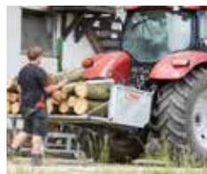
Ausklappbare Pendelwand dient als Muldenverlängerung
