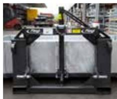
Aufnahmemöglichkeiten: Euronorm- und Dreipunkt- sowie Stapleraufnahme
