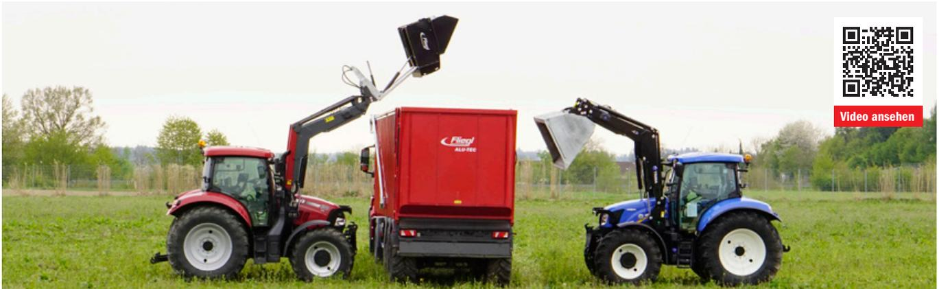
Darstellung der unterschiedlichen Kipphöhen bei gleichem Frontlader
