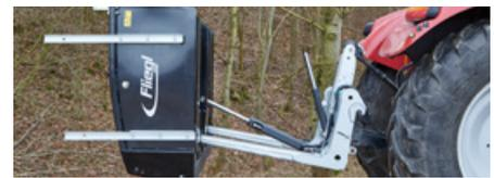
2-Zylinder-System für besten Kippwinkel 111°
