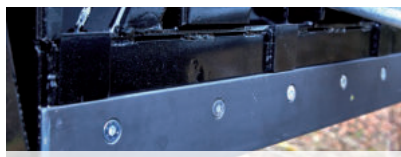
Geschraubte Schürfleiste, keine überstehende Schrauben
