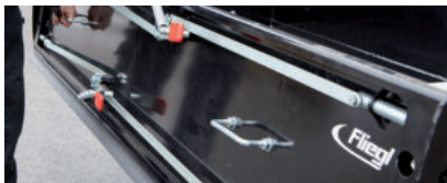
Schnelle und einfache Verriegelung der Klappwand
