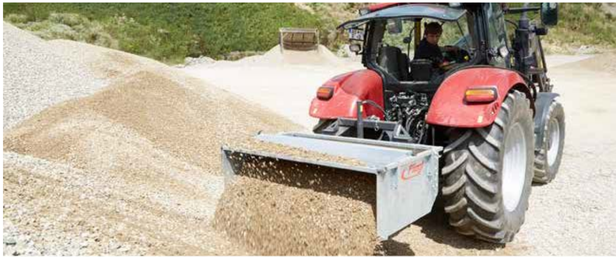
Zum Beladen eines Kippers mit z.B. Getreide, Kunstdünger usw.. Durch die besonders langen Auslegearme wird eine enorme Abkipphöhe erreicht.
