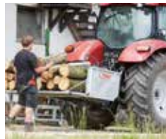
Ausklappbare Pendelwand dient als Muldenverlängerung
