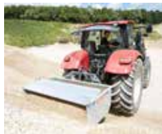
Abb. Pendelwand nach oben geklappt
