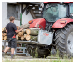
Ausklappbare Pendelwand dient als Muldenverlängerung
