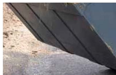
Versteifungsbleche sorgen für einen stabilen Unterbau
