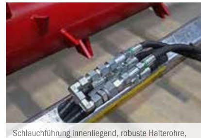
Schlauchführung innenliegend, robuste Halterohre, dadurch bester Schutz für Schläuche
