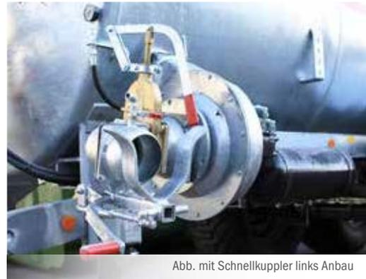
Abb. mit Schnellkuppler links Anbau
