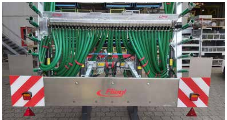
Schleppschuhdüsenenschutz mit Beleuchtung und Warntafeln für Straßentransport, optional erhältlich
