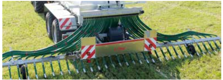
Transportschutz mit Beleuchtung und Warntafeln für Straßentransport, optional erhältlich
