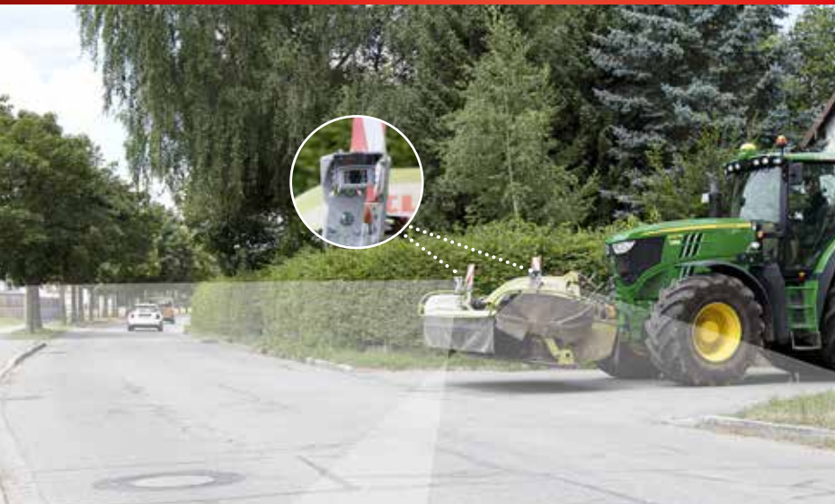
Kamerasystem - Anbau an einem Frontmäherwerk
