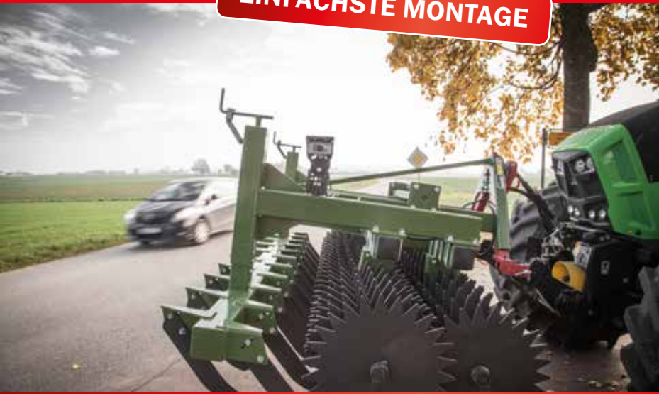
Kamerasystem - Anbau an einer Frontpackerwalze
