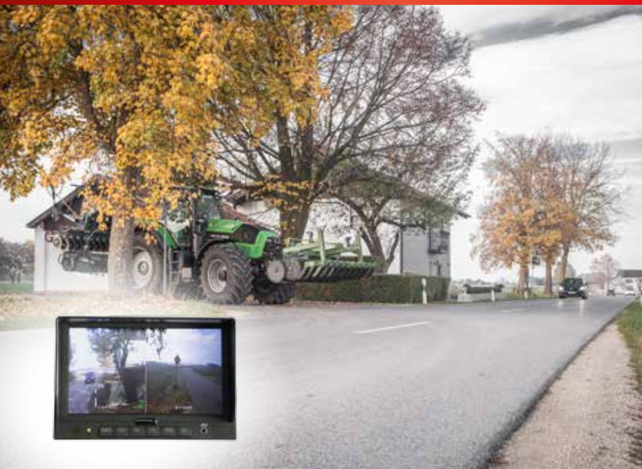
Gefahrensituation Straßenausfahrt: Durch das FLIEGL Vorbau-Kamerasystem »HAWK« muss sich der Schlepperfahrer nicht an die Kreuzung rantasten. Mit dem Splitscreen-Display hat er den links- und rechtskommenden Verkehr voll im Blick.
