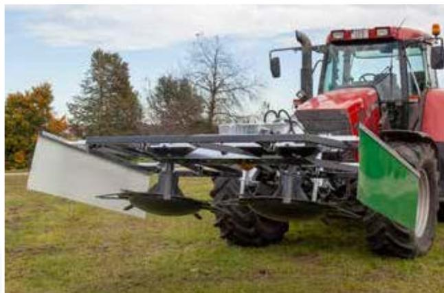
Flachsilverteiler Duo an der Fronthydraulik
