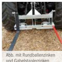
Abb. mit Rundballenzinken und Gabelstaplerzinken
