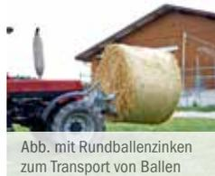
Abb. mit Rundballenzinken zum Transport von Ballen
