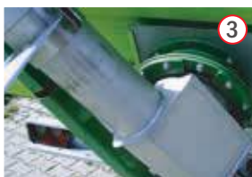
Über Drehgelenk einschiebbar in Fliegl-Kornschieber 400 x 300 mm.
