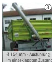
Über Drehgelenk einschiebbar am Fliegl-Kornschieber 400 x 300 mm
