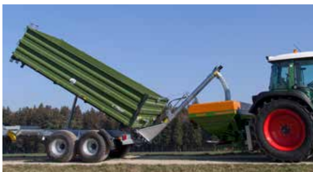
Die Überladeschnecke kann an jeden Kipper mit einfachster Montage angebracht werden. Die Bedienung ist mühelos. Stufenlose Verstellung des Austragewinkels mittels Seilwinde.
