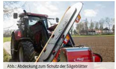
Abb.: Abdeckung zum Schutz der Sägeblätter
