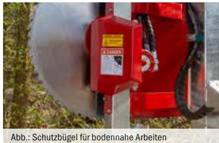
Abb.: Schutzbügel für bodennahe Arbeiten
