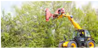
3-Blatt Astsäge am Teleskoplader mit JCB-Aufnahme
