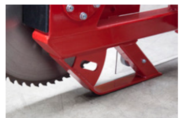
Ein Schutzbügel verhindert eine Berührung des untersten Sägeblattes mit dem Erdbreich.
