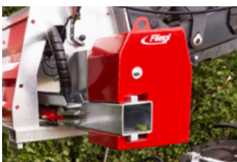
Seitliches Kontergewicht – dadurch minimale Belastung der Schwinge des Trägerfahrzeugs.
