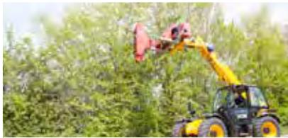
3-Blatt Astsäge am Teleskoplader mit JCB-Aufnahme
