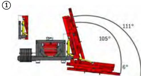
Neigevorrichtung 111° - zum Senkrecht- und Waagrechtsschneiden. Der Winkel kann dabei stufenlos eingestellt werden.
