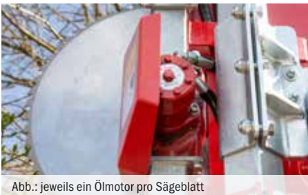
Abb.: jeweils ein Ölmotor pro Sägeblatt
