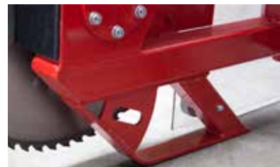
Ein Schutzbügel verhindert eine Berührung des untersten Sägeblattes mit dem Erdreich.
