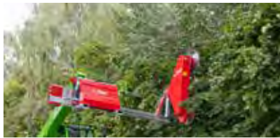
Astsäge (Ausführung links) an Merlo
