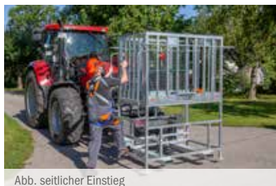
Abb. seitlicher Einstieg
