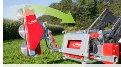
Astsägenkopf für Anbau links und rechts schwenkbar
