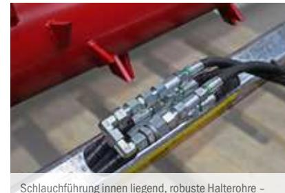
Schlauchführung innen liegend, robuste Halterohre – bester Schutz für Schläuche
