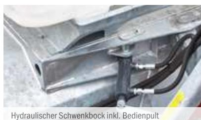
Hydraulischer Schwenkbock inkl. Bedienpult
