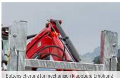
Bolzensicherung für mechanisch klappbare Erhöhung
