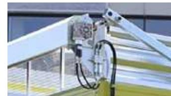
Hydraulischer Antrieb über Ölmotor – zum Einziehen des Netzes
