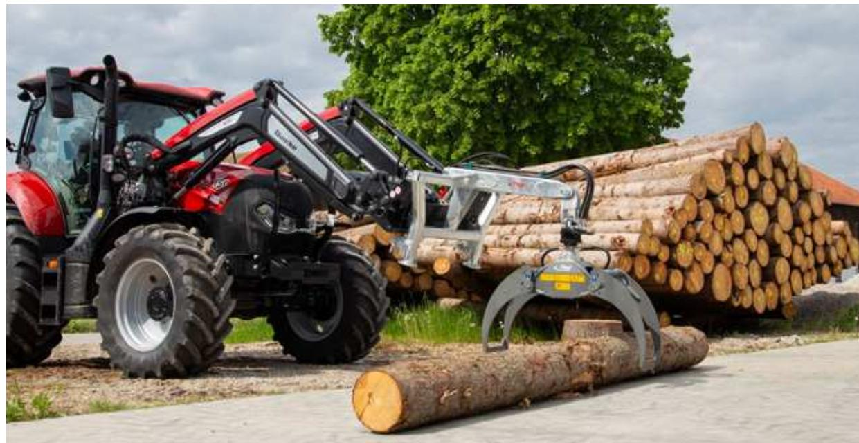
Verladezange mit Lasthakenverlängerung, Drehmotor, Euronorm- und Dreipunktaufnahme
