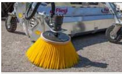
Mechanisch klappbarer Seitenbesen Ø 600 mm
