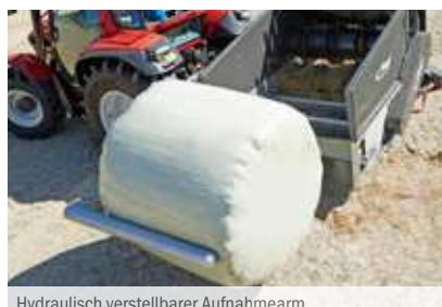
Hydraulisch verstellbarer Aufnahmearm
