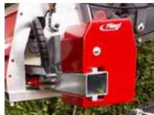
Seitliches Kontergewicht – minimale Belastung der Schwinge des Trägerfahrzeugs.
