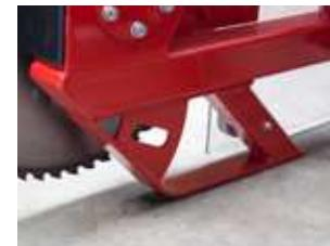
Schutzbügel verhindert Bodenkontakt des untersten Sägeblatts.
