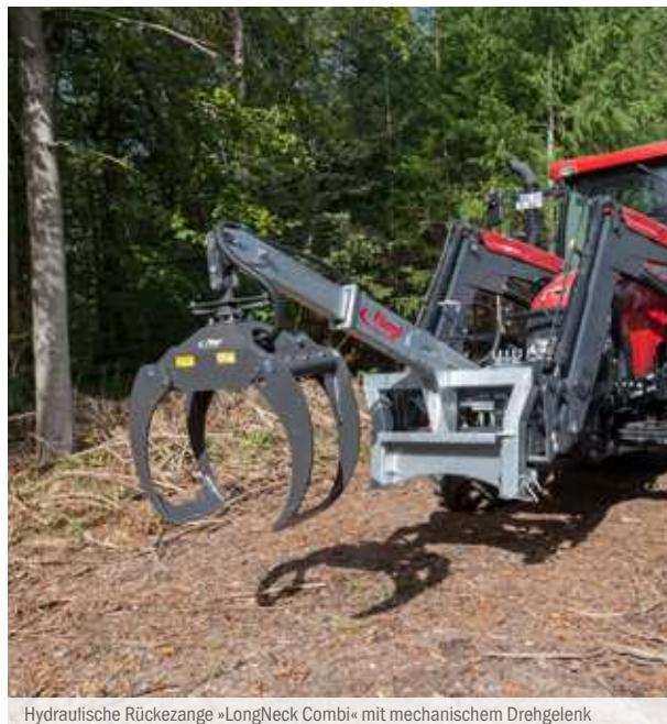
Hydraulische Rückezange »LongNeck Combi« mit mechanischem Drehgelenk
