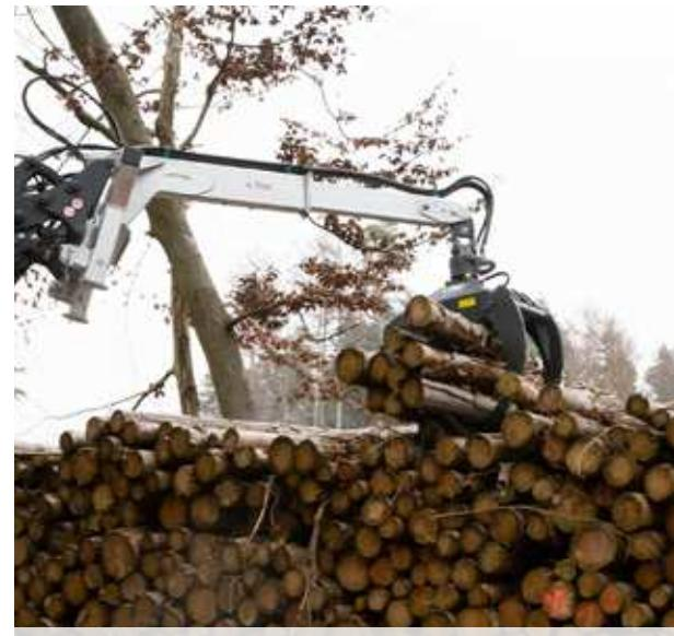
Hydraulische Rückezange »LongNeck Combi-Plus« mit Endlosdrehmotor
