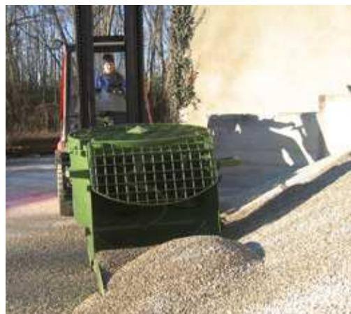
Füllen, Mischen, Entleeren – in einem Arbeitsgang
