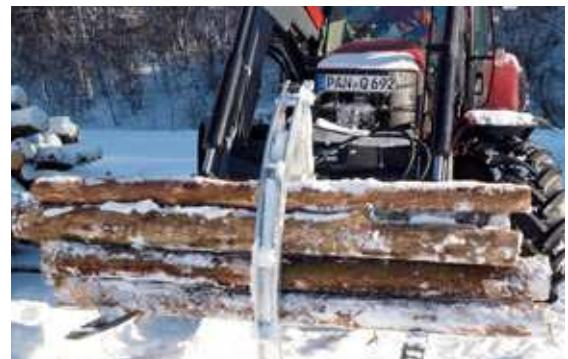
Hydraulischer Greifarm an der Kombi-Staplergabel »Freisicht« befestigt
