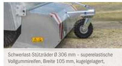
Schwerlast-Stützräder Ø 306 mm – superelastische Vollgummireifen, Breite 105 mm, kugellagiert, abriebfeste Lauffläche, schwere Drehkranausführung
