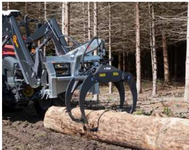
Hydraulische Rückezange »RZ 185 Combi« mit mechanischem Drehgelenk
