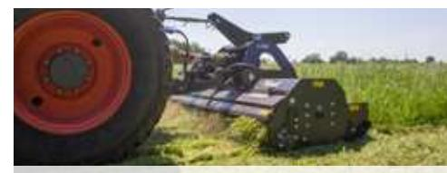
Einstellbare Klappe für sicheres Ablegen des Mulchguts
