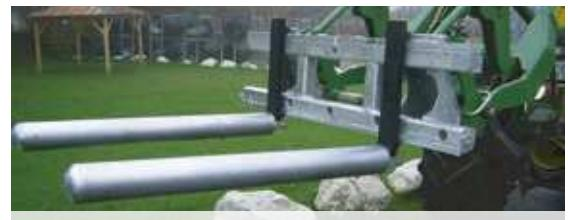
Aufsteckrohre für Rundballentransport mit Schrauben gesichert
