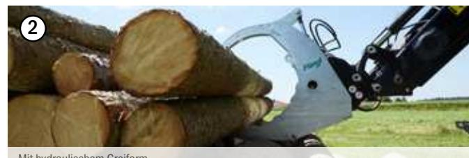
Mit hydraulischem Greifarm
