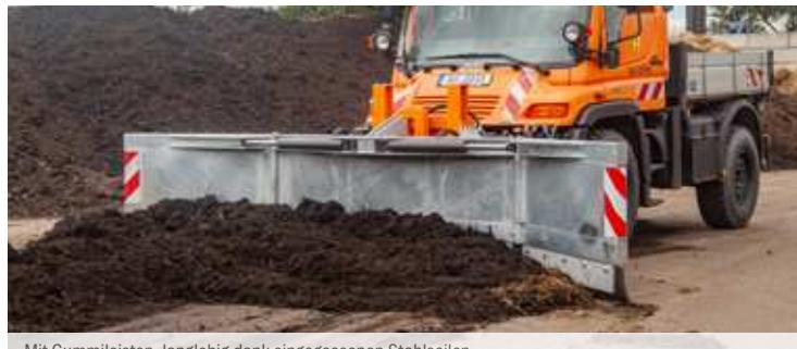
Mit Gummileisten, langlebig dank eingegossenen Stahlseilen
