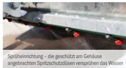
Sprühseinrichtung – die geschützt am Gehäuse angebrachten Spritzschutzdüsen versprühen das Wasser nah an der Bürste und verhindern Staubentwicklung
