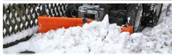
2 hydraulisch schwenkbare Flügel mit separater Ansteuerung
