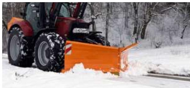
Verzinkt und zusätzlich lackiert für besten Korrosionsschutz
