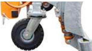
Schwerlast-Stützräder mit superelastischen Vollgummireifen:
