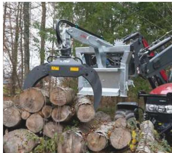
Hydraulische Rückezange »RZ 185 Combi-Plus« mit Polderschild (optional)
