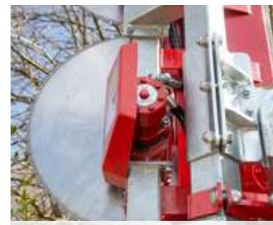
Antrieb der Sägeblätter über Ölmotore
