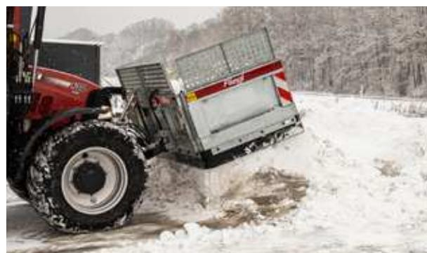
Räumbreite über die 2 Seitenflügel stufenlos einstellbar, Aufsatzzitter (optional)
