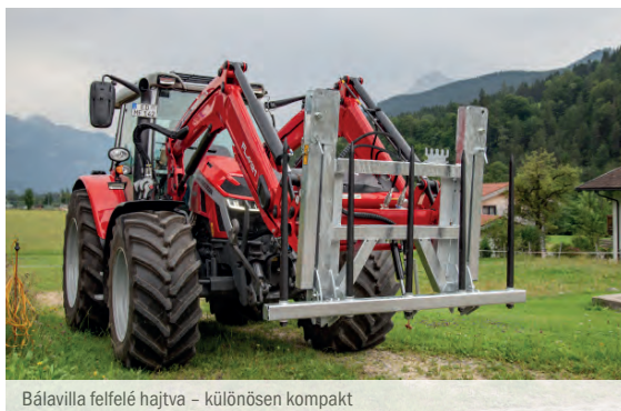
Bálavilla felfelé hajtva – különösen kompakt
