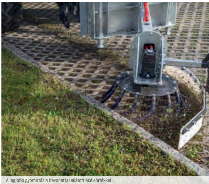
A legjobb gyomirtás a bevonattal ellátott acélsörtékkel
