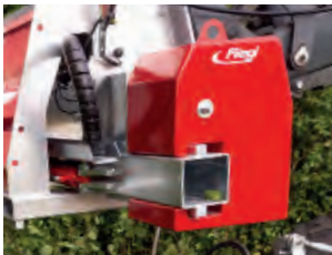
Oldalsó ellensúly - ezáltal a szállító jármű karjának terhelése minimális.
