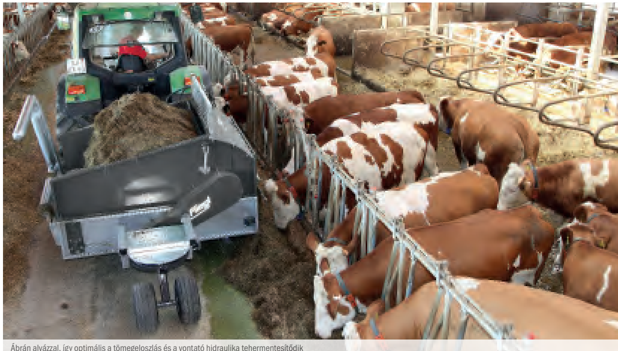
Ábrán alvással, így optimális a tömegelosztás és a vontató hidraulika tehermentesítődik
