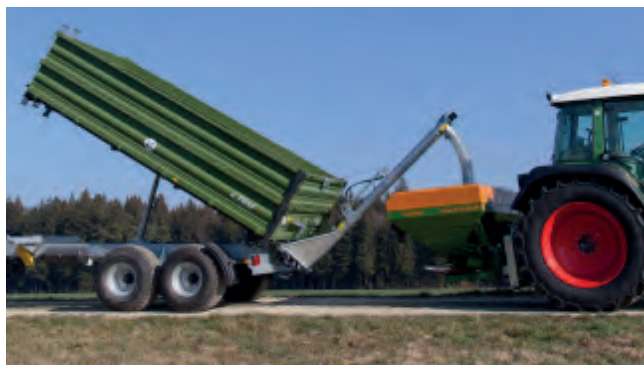
Az átrakó csiga minden billentős pótkocsira egyszerűen felszerelhető
