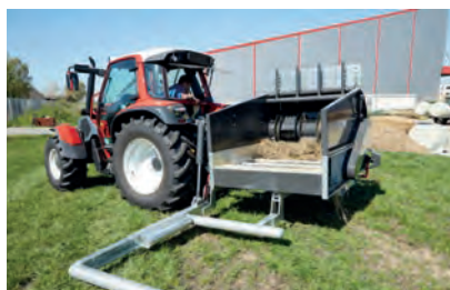
Ábrán a felvevőkar hidraulikus beállítás
