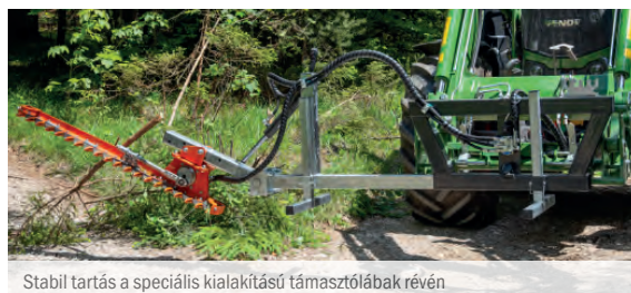
A finom fogazatú késpengék garantálják a tiszta vágási eredményt
