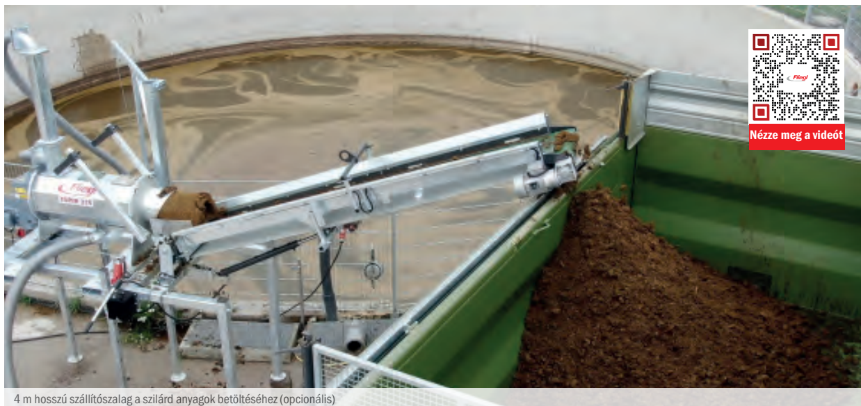
4 m hosszú szállítószalag a szilárd anyagok betöltéséhez (opcionális)
