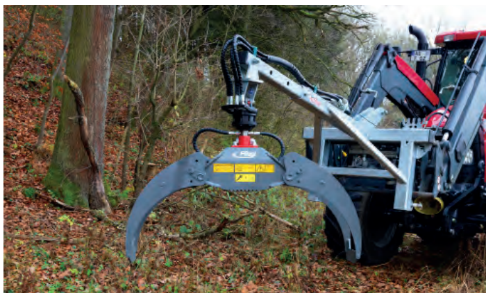
Rakodófogó teherkampó-hosszabbítással (Euro hárompontos felvevő) és hajtómotor
