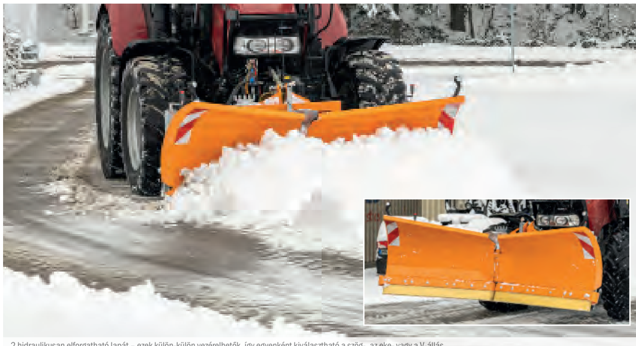
2 hidraulikusan elforgatható lapát – ezek külön-külön vezérelhetők, így egyenként kiválasztható a szög-, az eke- vagy a V-állás.
