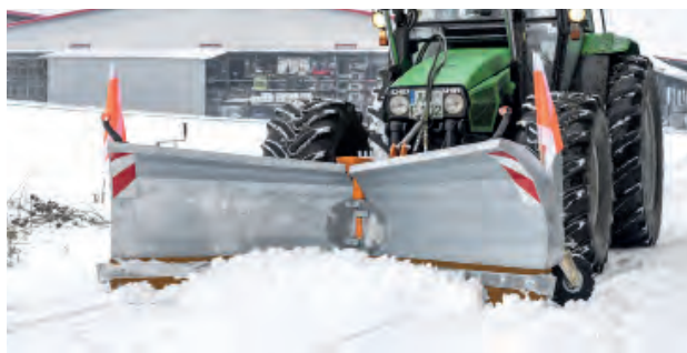
2 hidraulikusan elforgatható lapát – ezek külön-külön vezérelhetők, így egyenként kiválasztható a szög-, az eke- vagy a V-állás.
