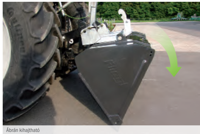
Ideális szög raklapvillák és kanalak szállításához
