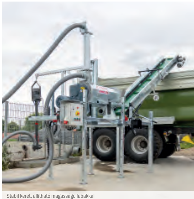
Stabil keret, állítható magasságú lábakkal
