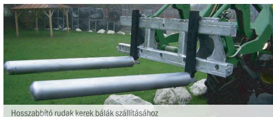
Hosszabbító rudak kerek bálák szállításához
