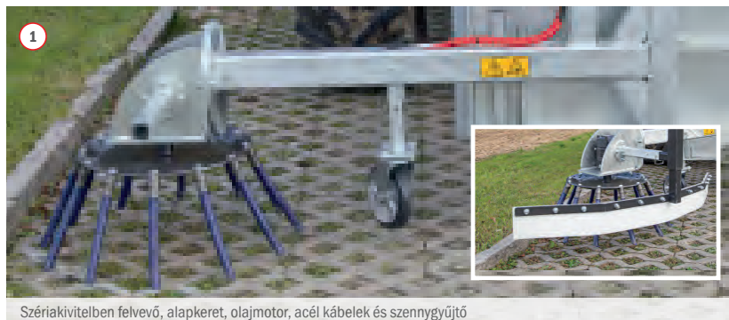
Szériakivitelben felvevő, alappokeret, olajmotor, acél kábelek és szennygyűjtő
