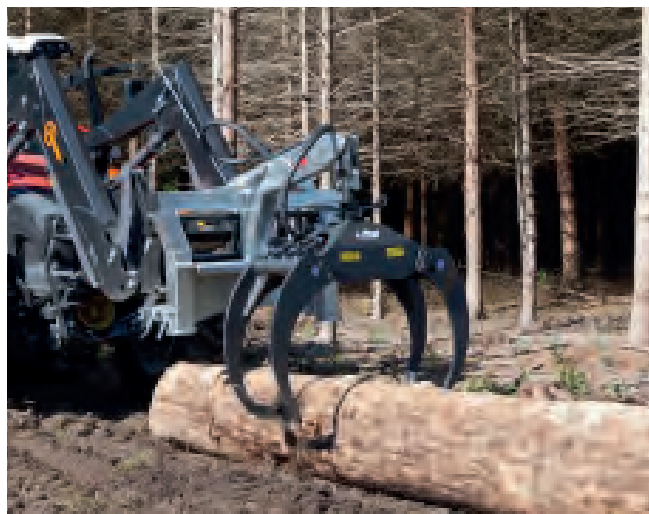
Combi RZ 185 hidr. rönkfogó mechanikus forgópánttal
