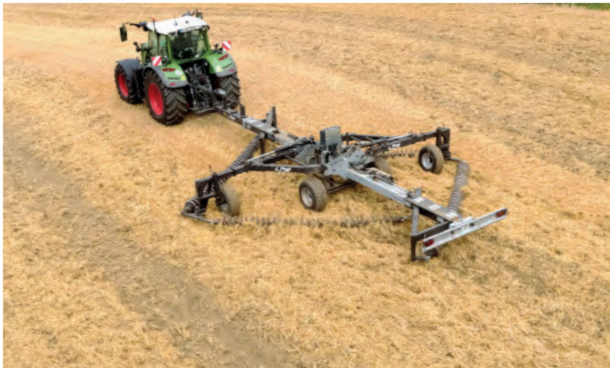
Nehéz láncok 51° és 58° közötti állítható megmunkálási szöggel
