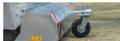
Strapabíró kerék rendkívül rugalmas tömörgumi abroncsokkal Ø 306 mm – Szélesség: 105 mm, golyócsapágyas, kopásmentes futófelület, hegesztett acélból készült strapabíró görgő, erős forgókoszorú
