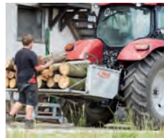
A kihajtható mobil fal meghosszabbítja a vályút
