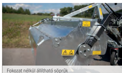
Fokozat nélkül állítható söprű
