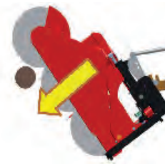
Tudnivaló: A vastag ágakat mindig fentről lefelé vágja, hogy elkerülje a fűrészlap beszorulását!
