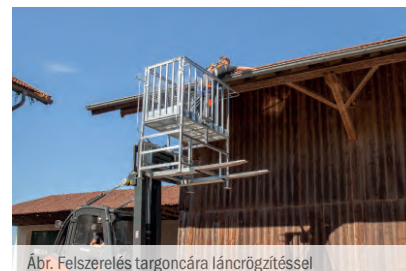
Ábr. felszerelés targoncára láncrögzítéssel
