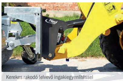
Kerekes rakodó felvevő ingakiegyenlítéssel
