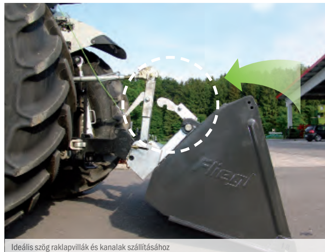
Ideális szög raklapvillák és kanalak szállításához
