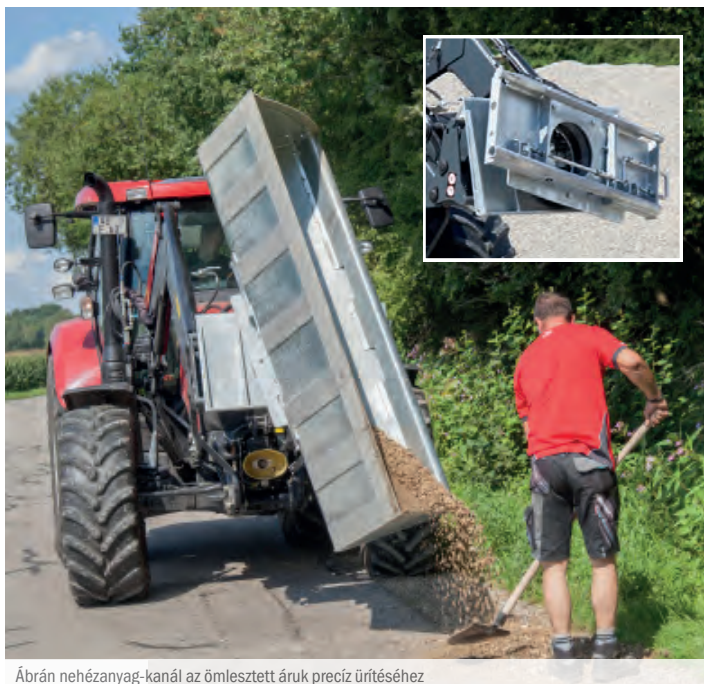
Ábrán nehézanyag-kanál az ömlesztett áruk precíz ürtéséhez
