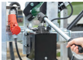
Kézipumpa a szallag magasságának állításához
