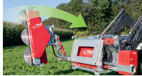
Az ágvágó feje a jobb és bal oldalra való felszereléshez elforgatható
