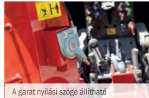
A garat nyílási szöge állítható
