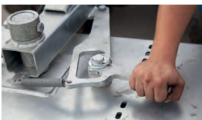
Mechanikus forgóbak (30°-kal balra és jobbra)
