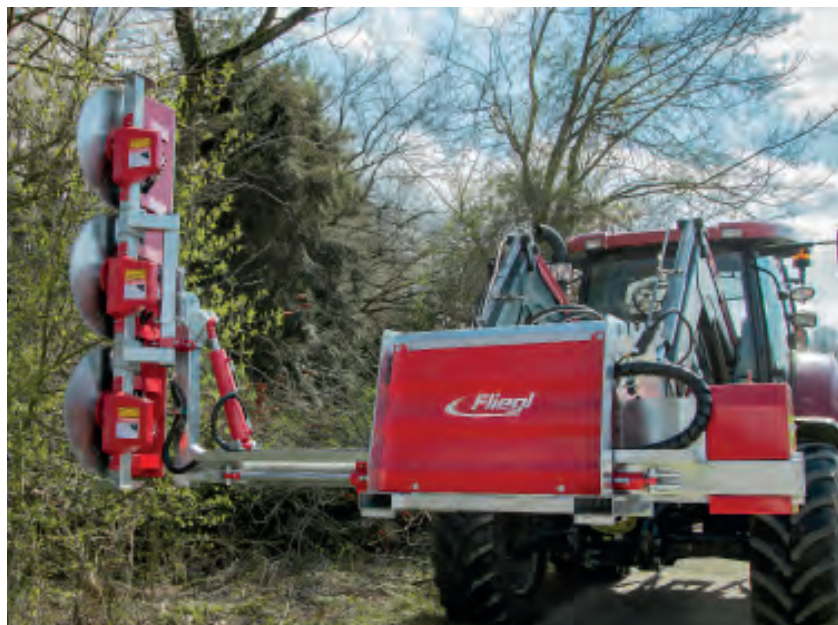
Lapos, speciálisan kialakított fűrészfej a legjobb láthatóság érdekében – ideális bokrok vagy durva aljnövényzet vágására
