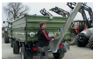
A kivetési szög könnyen beállítható
