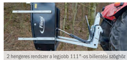
2 hengeres rendszer a legjobb 111°-os billentési szöghöz
