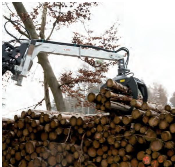
LongNeck Combi Plus hidraulikus rönkfogó folytonos hajtómotorral
