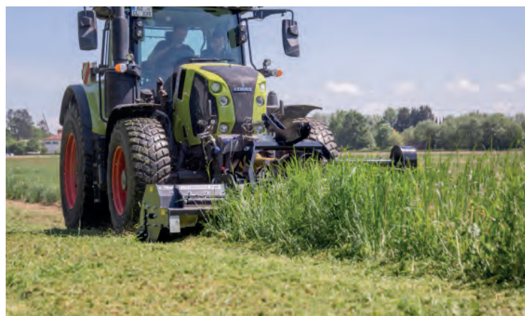
Állítható fedél a mulcs biztos lerakásához
