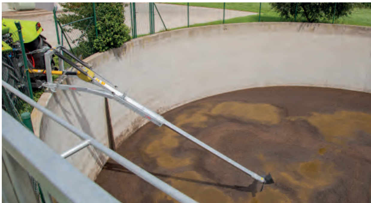
Hidraulikus összcukással – mély medencékben használható
