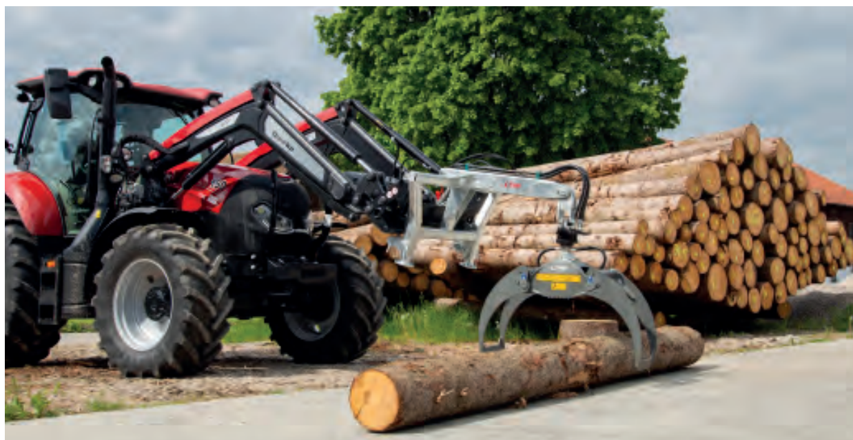
Rönkfogó tartókonzollal, forgómotorral, Euronorm- és hárompontos rögzítéssel
