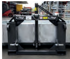
Felvételi lehetőségek: Euronorm- és hárompont-, valamint targoncafellevő
